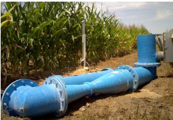
L'eQ-pipe 300/125 peut être mis en place dans une porte de rigole préfabriquée et standardisée, de même que l'eQ-pipe 300/125 (modèle discontinué) que l'on voit sur la photo, à l'aide d'un adaptateur de porte et un coude de 300 mm avec réduction (160 mm ou 200 mm), auquel le tuyau d'arrosage est raccordé.
