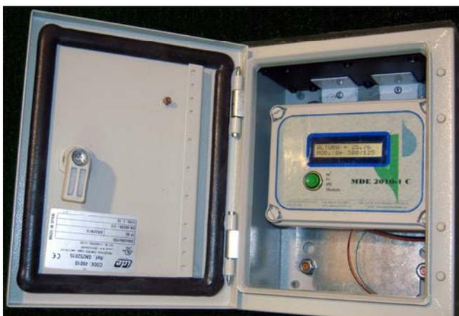
Il fait une lecture directe du débit en circulation en litres par seconde, étant donné que le software du Manomètre Différentiel Électronique (MDE 2010-C) dont il est muni, intègre l'équation qui rattache le différentiel de pression et le débit, pour chaque modèle de eQ-pipe.
