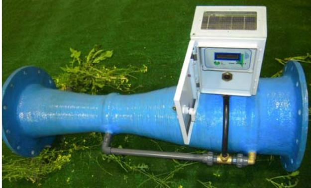
eQ-pipe 300/160 avec MDE 2010-C, un panneau solaire pour une autonomie totale.
